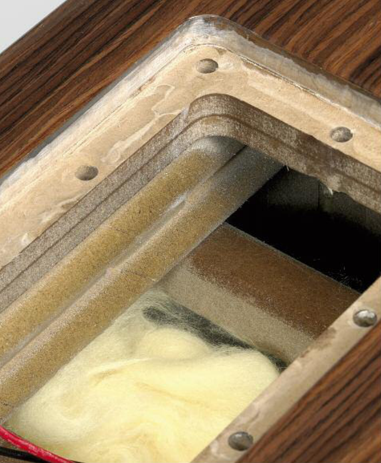
Doppelwhopper: Die Concept 500 ist 42 kg schwer, weil sich ihre Gehäusewände aus drei Schichten MDF mit jeweils einer Zwischenschicht nicht aushärtenden Gels zusammensetzen. Das soll Resonanzen absorbieren und Vibrationen in Wärme umwandeln
