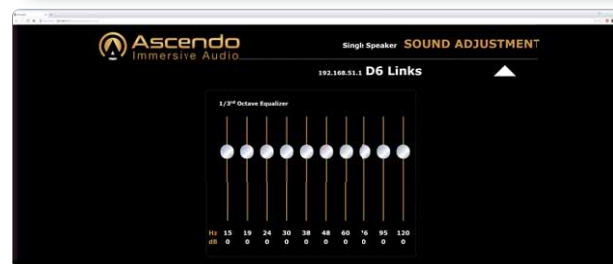
Hier im Bild ist der 1/3-Oktav-Equalizer für die Einstellung der tiefen Frequenzen von 15 bis 120 Hertz zu sehen. Jeder Lautsprecher kann einzeln korrigiert werden
