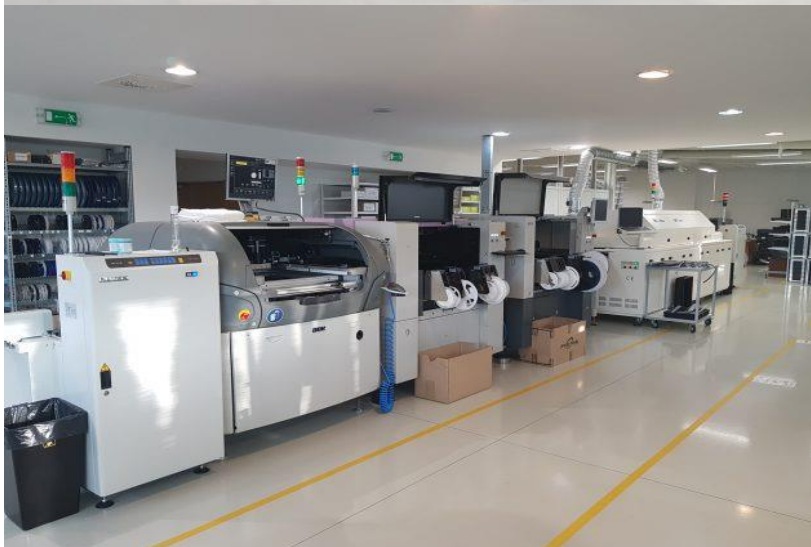
Mit der automatisierten SMT-Fertigungslinie lassen sich Platinen in perfekter Qualität bestücken und verlöten.
