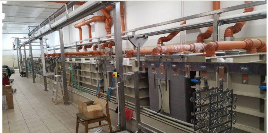
Die Eloxierung von Aluminiumteilen erfolgt hausintern.
