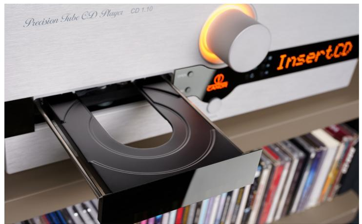
Die CD-Schublade ist im geschlossenen Zustand perfekt im schwarzen Band versteckt. Im geöffneten Zustand sieht man die Führungsschienen des CD-Schlittens, die Canor zur zusätzlichen Stabilisierung eingesetzt hat.
