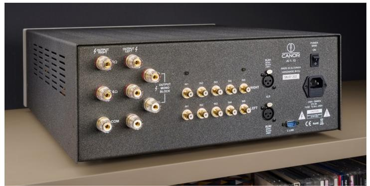
Die Rückseite des AI 1.10: Als rein analog gehaltener Verstärker bietet er fünf unsymmetrische Eingänge, ausgangsseitig offeriert er getrennte Klemmen für Vier-Ohm- und Acht-Ohm-Lautsprecher. Über die XLR-Buchsen und die C-Link-Schnittstelle kann der Amp in Verbindung mit einem zweiten AI 1.10 als Doppel-Mono-Blöcke betrieben werden – ohne eine zusätzliche Vorstufe.
