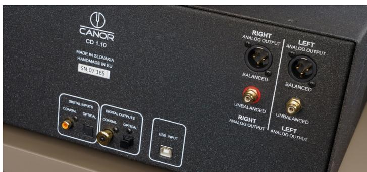
Die Schnittstellen machen den CD 1.10 flexibel: Mit den USB- und S/PDIF-Eingängen ist er als DAC einsetzbar, mit den S/PDIF-Outs ist er als reines Laufwerk nutzbar, über die analogen Ausgänge stellt er das selbst gewandelte und röhrenverstärkte Signal zur Verfügung - sowohl symmetrisch via XLR als auch unsymmetrisch per Cinch.
