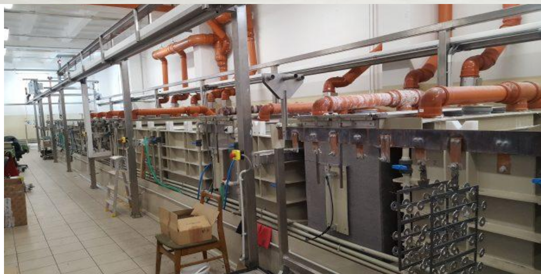
Aluminium onderdelen worden intern geanodiseerd.
