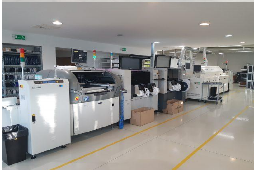
Met de geautomatiseerde SMT-productielijn kunnen printplaten in perfecte kwaliteit worden geassembleerd en
