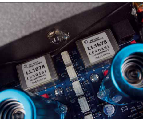
Die beiden Übertrager heben MC-Signale auf MM-Niveau an
