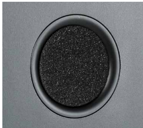
Die Bassreflexöffnung lässt sich bei Bedarf mit einem Schaumstoffstopfen verschließen, um den Bass bei wandnaher Aufstellung abzuschwächen.
