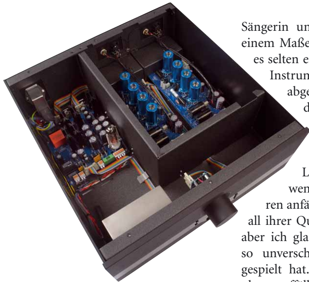
Versorgungs- und Signalteil sind fein säuberlich voneinander getrennt
