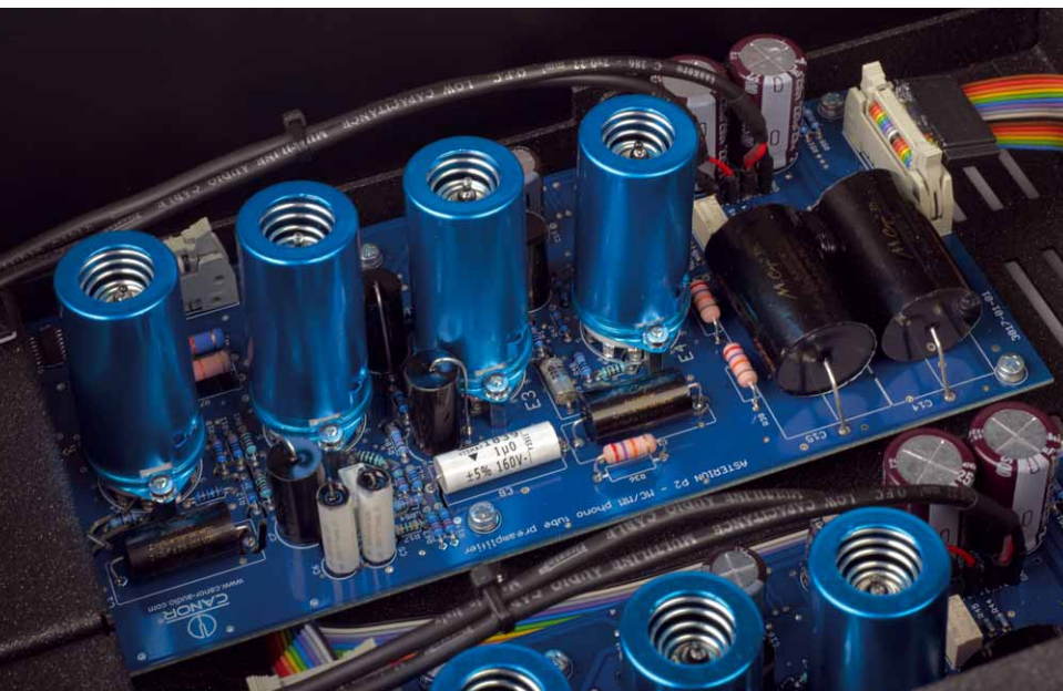
Acht Doppeltrioden 6922 im Abschirmbecher besorgen die Verstärkung
