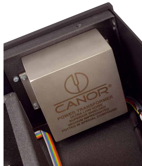
Der gründlich gekapselte Ringkerntrafo steckt hinter der Gerätefront
