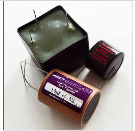
Ein paar der Preziosen, die auf der Weiche der „Episode 2“ zum Zuge kommen. Der vergossene Trafo oben ist noch ein Prototyp
