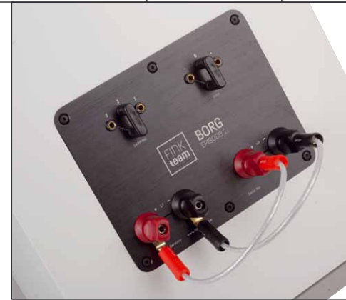
Das neue Anschlussfeld mit Bi-Wiring-Brücken
