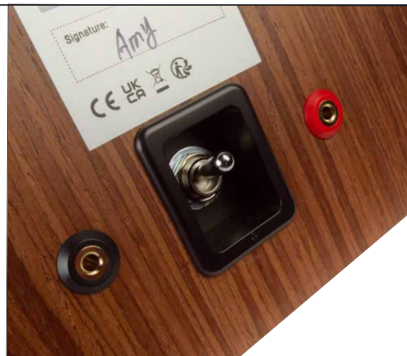
Der Kippschalter ist fürs Einstellen der Raumanpassung zuständig
