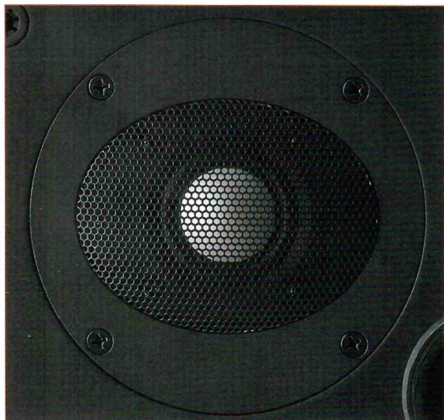
Der Hochtöner ist genau der gleiche wie beim größeren Modell ES-14N. Er übernimmt vom Tief-Mittentöner bei 2000 Hz
