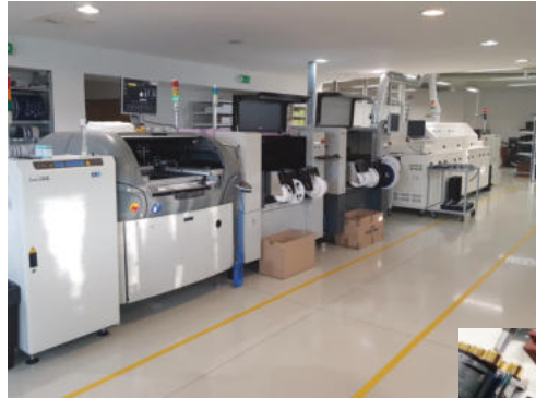
Mit der automatisierten SMT-Fertigungsline lassen sich Platinen in perfekter Qualität bestücken und verlöten.
