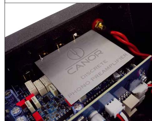
Unter dem Blech steckt ein Kanal des diskret aufgebauten Phonoteils
