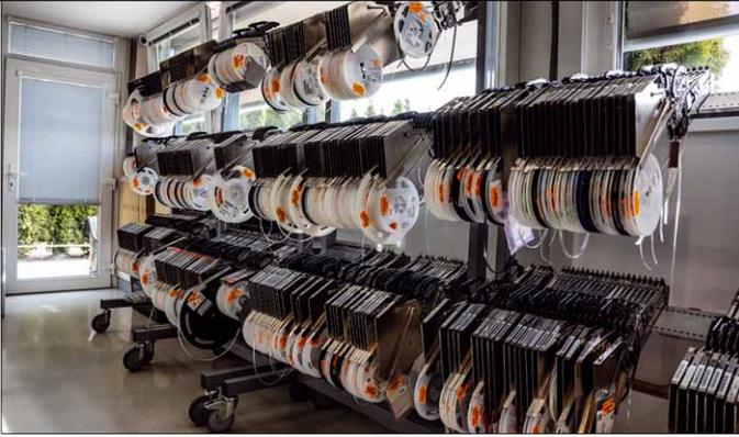
*SMD-Bauteile? Gibt's bei Canor reichlich, Platinen werden selbstredend ebenfalls selbst bestückt*
