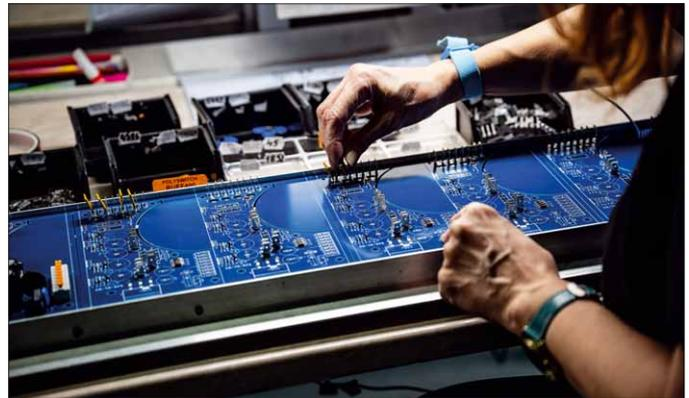
*Konventionelle Bauteile – also solche mit Drahtanschlüssen – werden mit der Hand bestückt*
