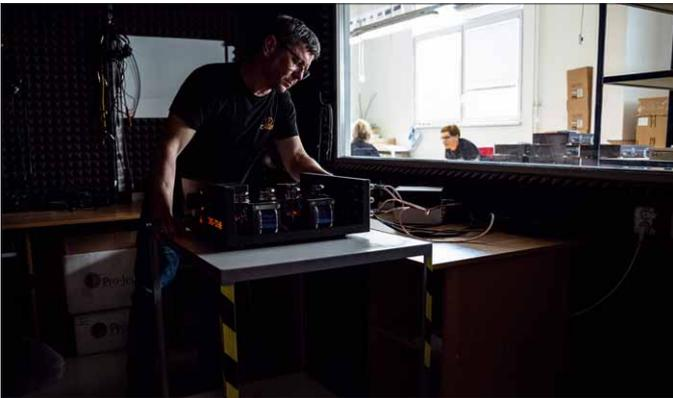
*Ein abgedunkelter Raum hilft bei der Funktionskontrolle von Röhrengeräten*
