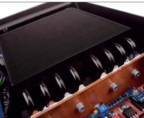
Das Kühlkonzept arbeitet mit Heat Pipes zur Wärmeabfuhr
