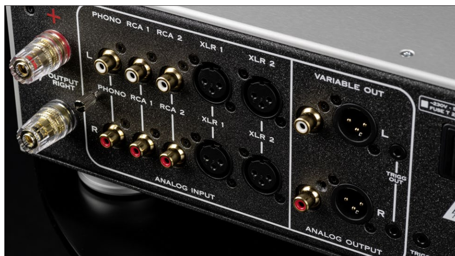
Die klar gegliederte Rückseite bietet neben Phono und Cinch auch Ein- und Ausgänge in XLR-Norm sowie insgesamt sechs digitale Eingänge inklusive USB-C und AES/EBU.
