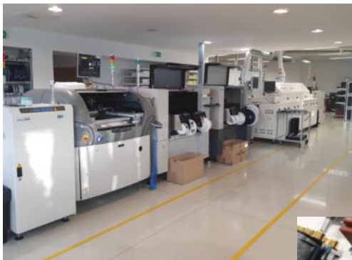
Met de geautomatiseerde SMT-productielijn kunnen printplaten in perfecte kwaliteit worden geassembleerd en gesoldeerd.
