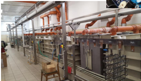
Het anodiseren van aluminium onderdelen gebeurt in eigen huis.
