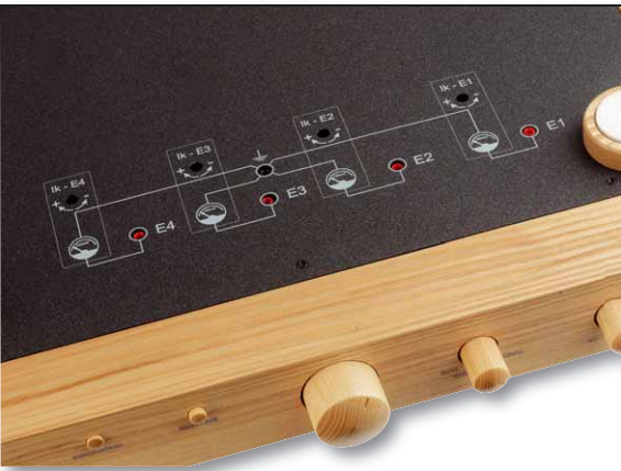
Die Ruhestrome der Endröhren werden auf der Geräteunterseite eingestellt
