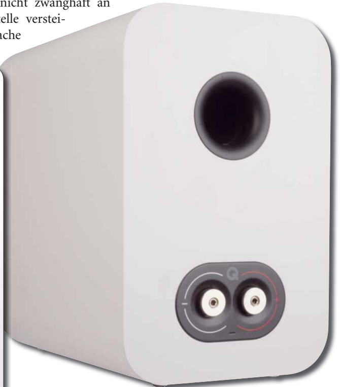
Trotz der Bassreflexöffnung und wegen der flachen Terminals kann man die 5020 nah an Rückflächen platzieren
