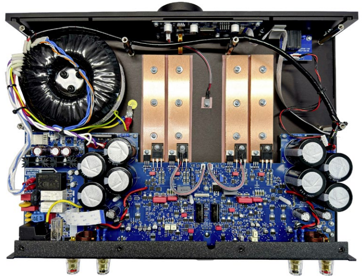
Der lautlos agierende Lüfter und die Kühlkörper aus Kupfer sorgen für eine gleichmäßige Temperaturumgebung der Transistoren.
