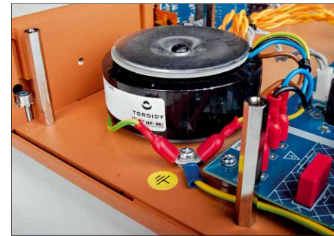
Ein Linearnetzteil mit sehr gutem, bedämpften und entkoppeltem Ringkerntrafo
