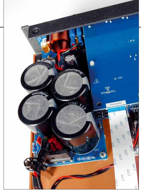
Die Netzteilplatine mit Entstörung im Hintergrund an Bord. Die Canor-Leute können es einfach
