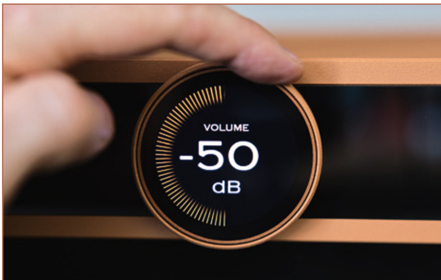
Das kreisrunde Touchscreen-Display ist direkt in den massiven Lautstärkeregler integriert. Wischgesten wechseln die Quelle, die Lautstärke lässt sich präzise in 1-dB-Schritten regeln
